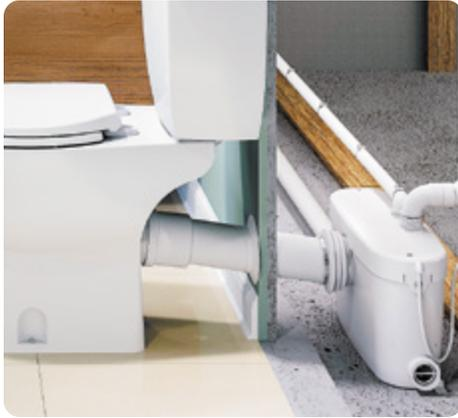
Le tuyau d'extension de 18" a été conçu pour faciliter l'installation et la **dissimulation de l'unité et de la plomberie derrière le mur**. Il est muni d'un joint interne qui se raccorde au raccord arrière de la toilette Saniflo, pour un raccordement étanche.
